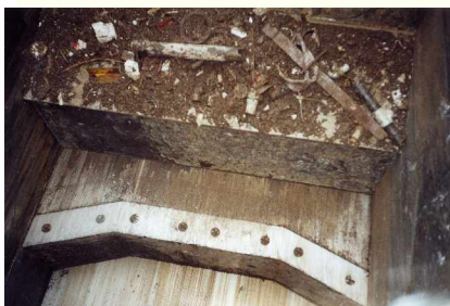
Fig. 5: Vue du chariot avec ses lames, prenant toute la largeur de coupe.
