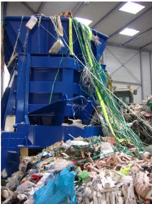
Bild 52: Gurte/Schläuche in Schere
