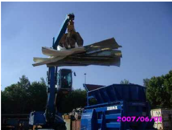
Bild 16: Chargierung von Profilen
