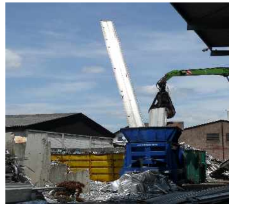
Bild 35: langes Alu-Profil in Aufgabebunker
