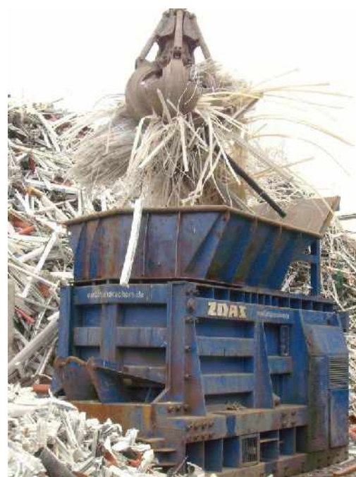
Bild 53: Fensterprofile in Schere
