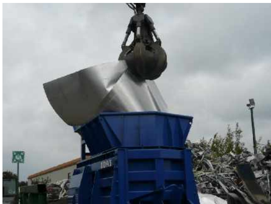
Bild 30: Alu-Bleche in Aufgabebunker
