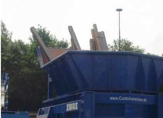
Bild 22: Trägerschrott in Aufgabebunker
