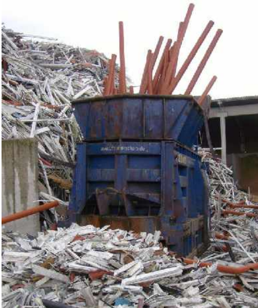
Bild 54: PVC-Rohre in Schere
