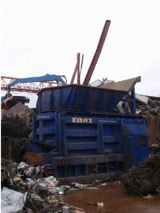
Bild 14: Träger in Schere
