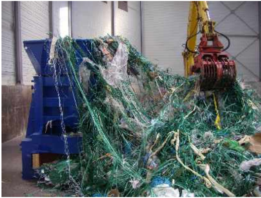
Bild 50: Gurte, Bänder, Schläuche in Schere
